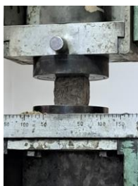
Fig. 5. 67. Așezarea și alinierea pieselor pe suportul presei mașinii de încercări mecanice
