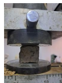
Fig. 5. 68. Cărămida după comprimare, a - forța aplicată; b - cărămida după comprimare.
