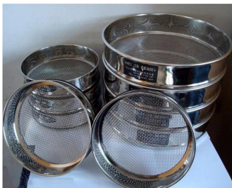
Fig. 5. 1. Set site etalon pentru de separarea pulberilor [ 6 ]
